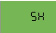
Nun wechselt der Klimaregler automatisch in den Standheizungsbetrieb. Bei aktivem Standheizungsbetrieb wird „SH“ angezeigt. Während dieser Zeit haben die Tasten des Klimareglers keine Funktion.
