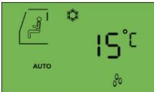
Durch Einstellen der Soll-Temperatur kann die Heizleistung manuell geregelt werden. Dazu wird der gesamte Bereich von der minimalen Soll-Temperatur (15°C) bis zur maximalen Soll-Temperatur (35°C) genutzt. Eine niedrige Soll-Temperatur ergibt eine geringe Heizleistung. Ein hoher Wert ergibt eine große Heizleistung.
