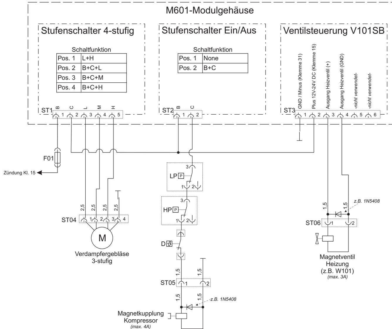
**ACHTUNG:** Angaben zu Kabelquerschnitten und Sicherungen sind Richtwerte. Bei der Umsetzung müssen diese Werte entsprechend der verwendeten Komponenten angepasst werden!
